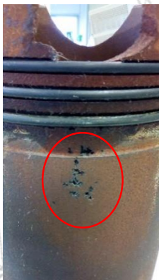
Wżery na tłoku w wyniku kawitacji płynu chłodzącego.
