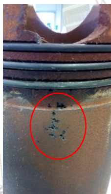
Picaduras en el pistón debido a los fenómenos de cavitación del LDR.
