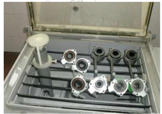
Salzsprühtest (zur Korrosionssimulation)
