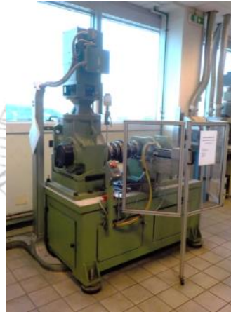
Beispiele: Ermüdungstest auf Mechanikprüfstand
