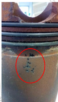
Piqures sur piston dues aux phénomènes de cavitation du LDR.
