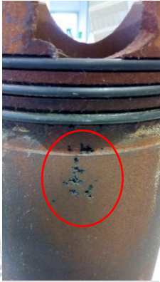
Lochfraß an den Kolben durch Kavitation des Kühlmittels.
